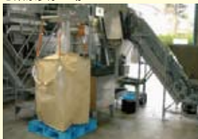
中身と容器を分離し容器は破碎洗浄乾燥し通い箱式フレコンバックに詰めて製紙会社に引き渡されます。
